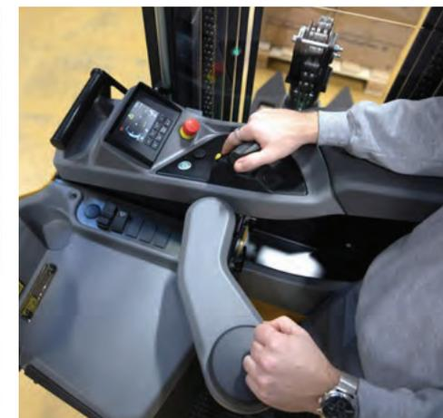
Más compacto y maniobrable que un apilador de plataforma, sus sistemas avanzados de conducción, elevación, descenso, dirección y estabilidad ayudan a que cada operación sea más rápida y fluida. Específicamente en aplicaciones de pasillos angostos, usted puede hacer el trabajo más rápido, con menos montacargas y menos operadores.
